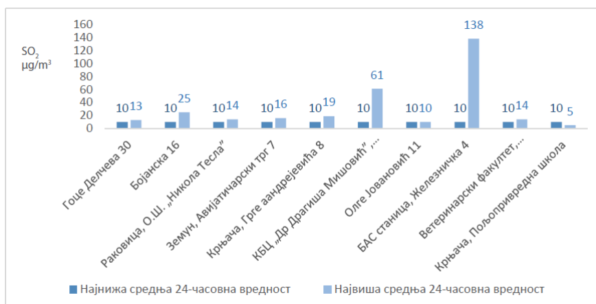
Grafikon 3. Najniža i najviša srednja 24-časovna vrednost za sumpor dioksid (poluautomatske metode) u 2017. Godini
