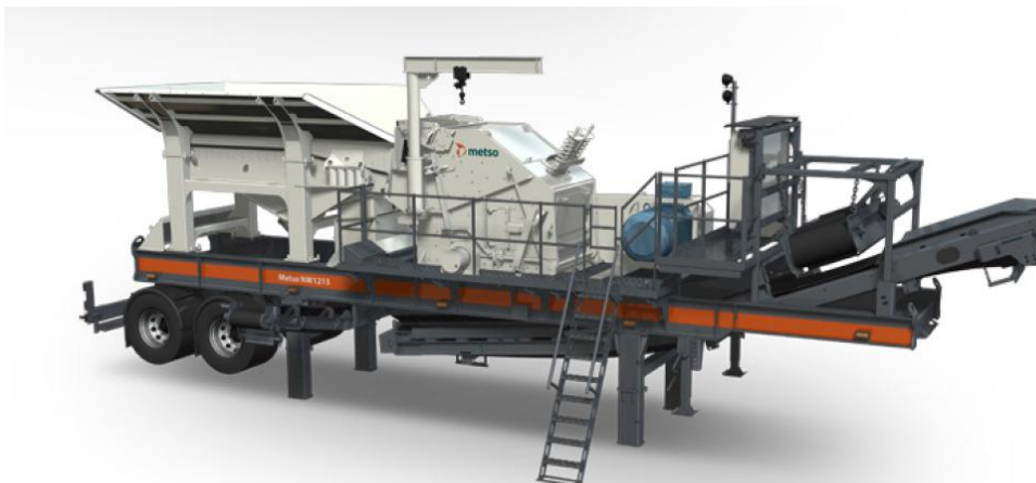
Slika 37. Ilustracija mobilnog drobiličnog postrojenja za tretman građevinskog otpada
