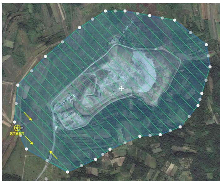
Slika 122. Šira zona deponije u Vinči sa prikazanim putanjama drona tokom fotogrametrijskih merenja
