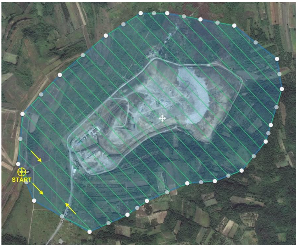
Slika 67. Šira zona deponije u Vinči sa prikazanim putanjama drona tokom fotogrametrijskih merenja
