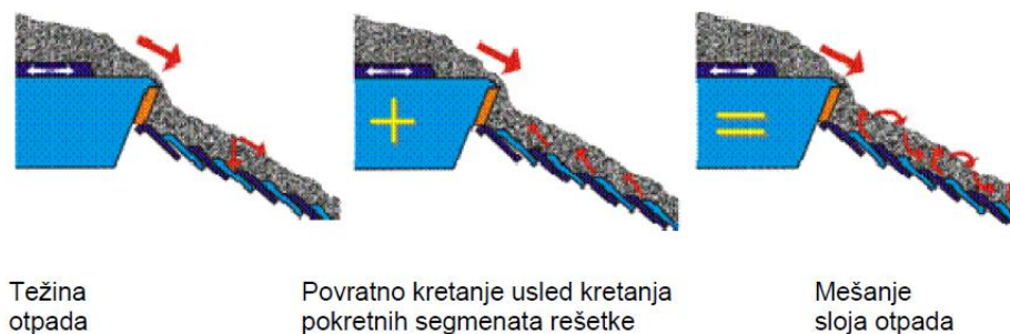
Slika 20. Tok kretanja otpada na povratnoj rešetki (ilustracija)
